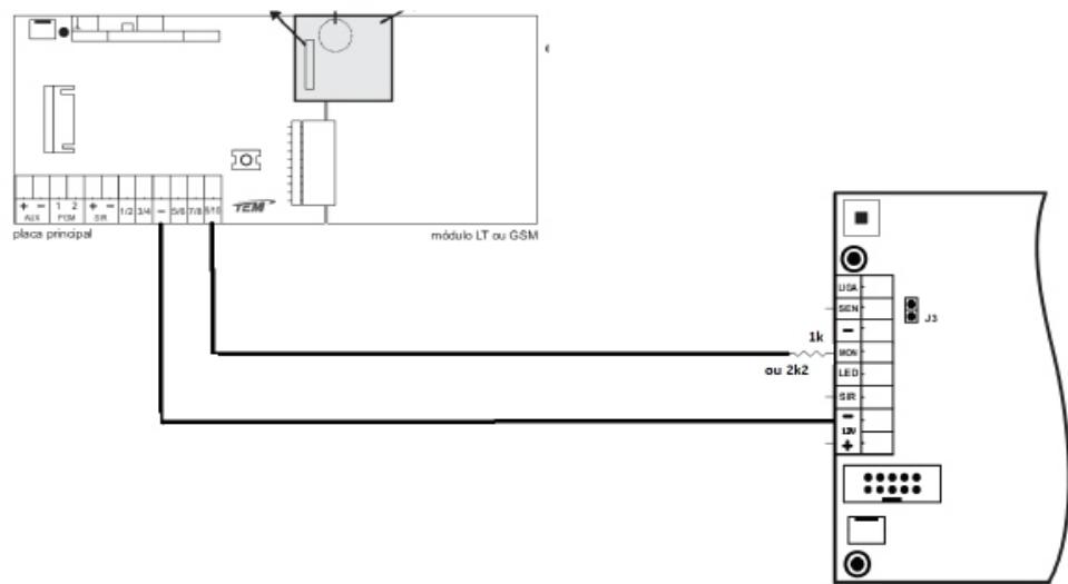
Esquema de ligação para acionamento do eletrificador através do aplicativo FLEX-1080 GSM
